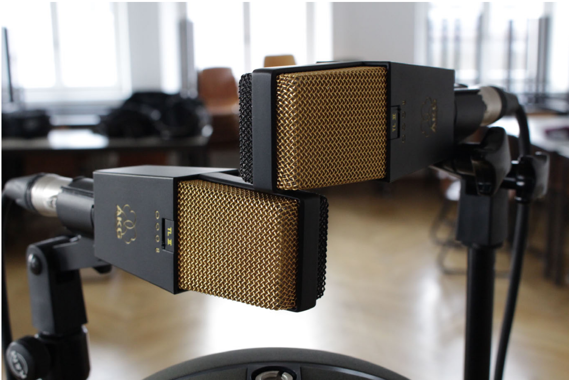
Abbildung 1: Blumleinaufstellung mit zwei gekreuzten Achtermikrofonen (AKG C 414)
